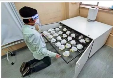
Uno de los primeros equipos de Lightwash, instalados en la ex Posta Central y el Hospital Sótero del Río, permiten desinfectar 60 mascarillas en 10 minutos con luz UVC.
