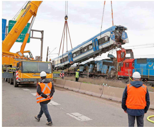
Cerca de nueve horas tomaron los trabajos con grúas para sacar el vagón principal del tren de pasajeros de EFE que quedó prácticamente arriba del tren de carga de Fepasa al colisionar la medianoche de ayer. El primero realizaba pruebas de velocidad a la altura del kilómetro 26 de la Ruta 5 Sur, en el sector de Lo Herrera, cuando por razones que se investigan impactó con el de carga, con un saldo de dos fallecidos y nueve heridos.
