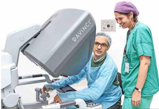
El Sistema de Cirugía Robótica Da Vinci X pertenece a la cuarta generación de sistemas quirúrgicos y cuenta con brazos más pequeños y delgados, que permiten un alcance más amplio que las versiones anteriores. Esto aumenta la capacidad para operar con precisión y destreza, reduce el temblor y entrega una visión excepcional de la anatomía del paciente. En la imagen, el Dr. Raimundo Domínguez, urólogo del Hospital Clínico Félix Bulnes, y María Elizabeth Silva, especialista clínica en Cirugía Robótica Da Vinci de Reich.
