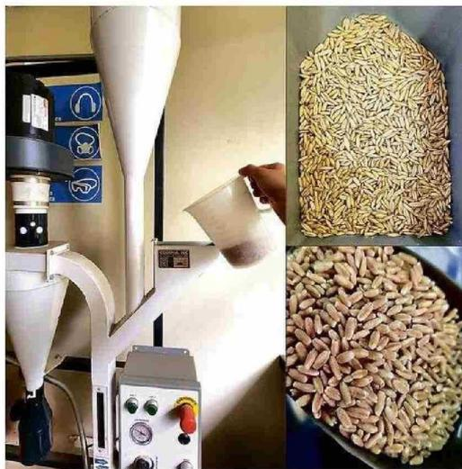
Análisis determinación % extracción en peladora de avena.
