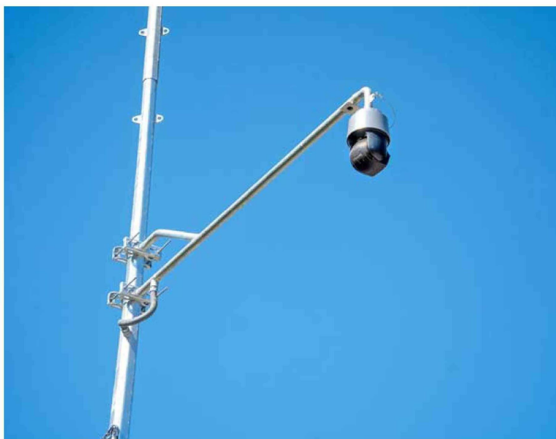
Cámaras poseen un potente zoom para acercar vistas con una distancia de 400 metros.
