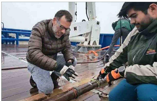
Los investigadores preparan termómetros submarinos de precisión en una sonda que, luego, bajaron para recolectar información de la zona.
