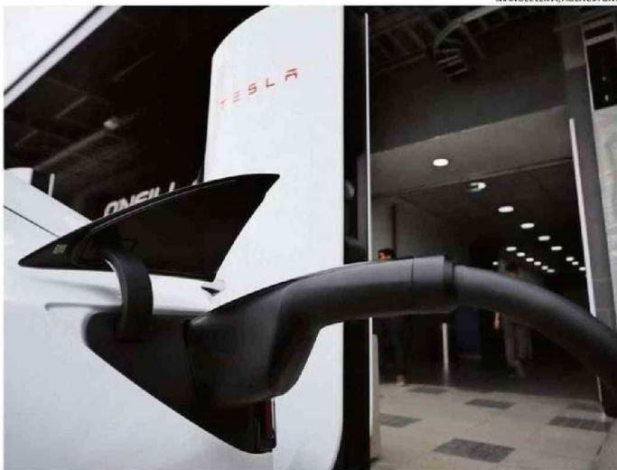
EL “SUPER CHARGER” PERMITE LLENAR LA BATERÍA DEL TESLA EN UNOS 20 MINUTOS.
