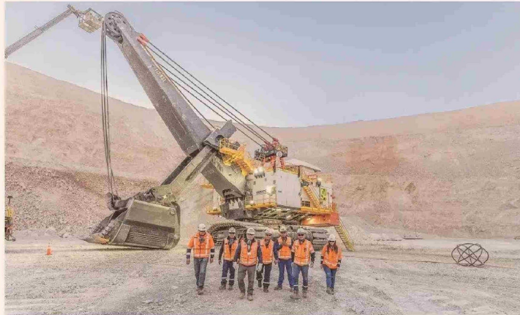
Escondida | BHP opera desde junio con la primera pala eléctrica de mayor capacidad a nivel mundial, el modelo 4800XPC de Komatsu.
