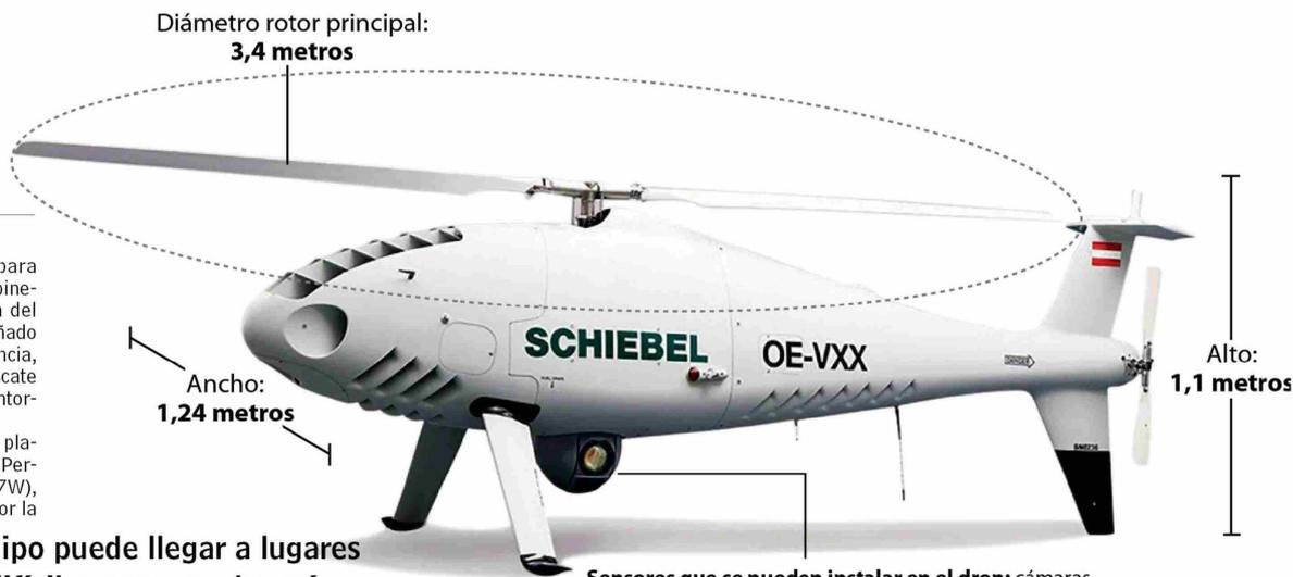
**Sensores que se pueden instalar en el dron:** cámaras electro-ópticas e infrarrojas (EO/IR), radar de apertura sintética (SAR/GMTI), sensores de inteligencia, comunicaciones y reconocimiento (ISR), radar de penetración terrestre (GPSAR), altavoces.
