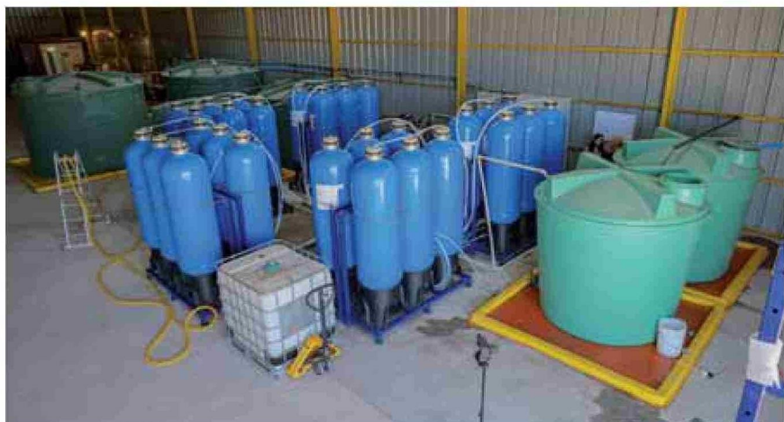
Planta piloto de Extracción Directa de Litio.
