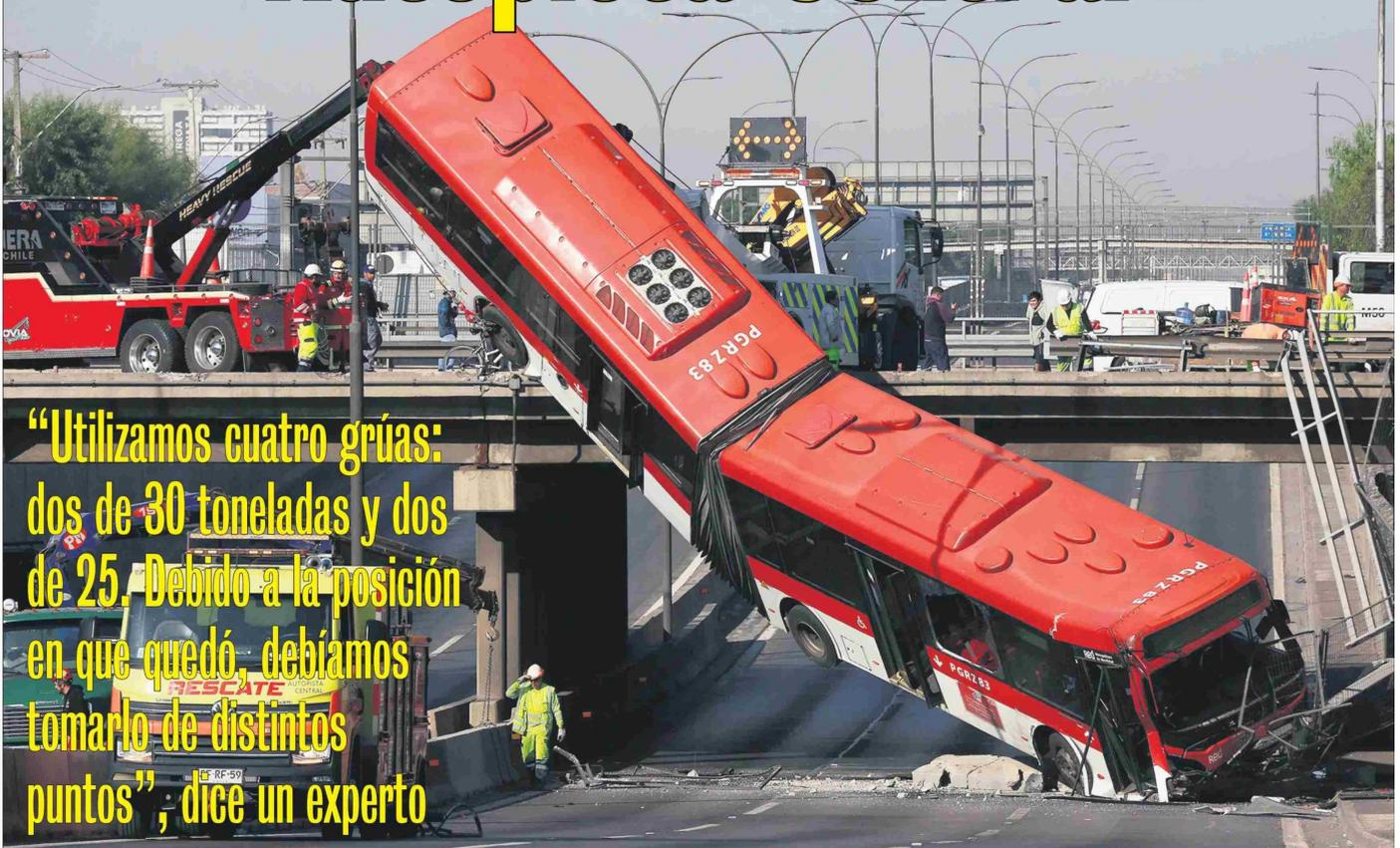
“Utilizamos cuatro grúas: dos de 30 toneladas y dos de 25. Debido a la posición en que quedó, debíamos tomarlo de distintos puntos”, dice un experto
