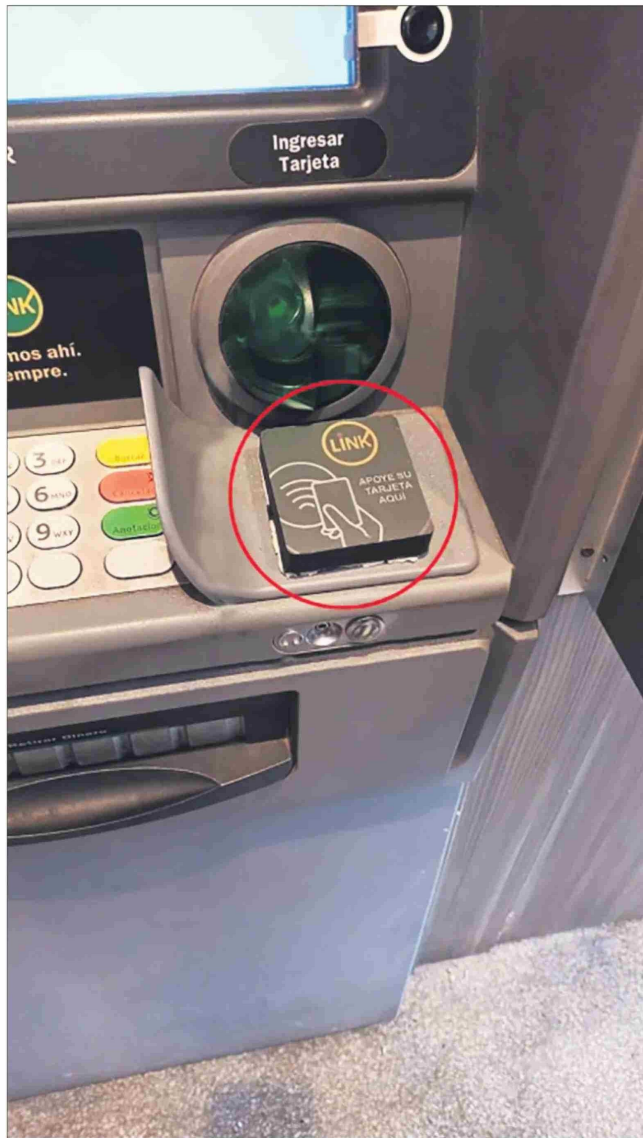
El skimmer es capaz de clonar la tarjeta sin necesidad de contacto.
