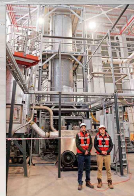
Este es el reactor que permite que el plástico pueda volver a ser usado en botellas para consumo humano
