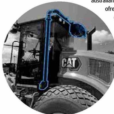
que filtra el aire en dos etapas: primero el particulado grueso, y después el fino mediante un filtro HEPA de alta eficiencia.
