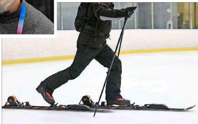
Esquíes con asistencia eléctrica es la apuesta de E-Skimo. Se trata de un sistema que ayuda a subir cuando no hay andarríeves y a avanzar en terrenos planos.
