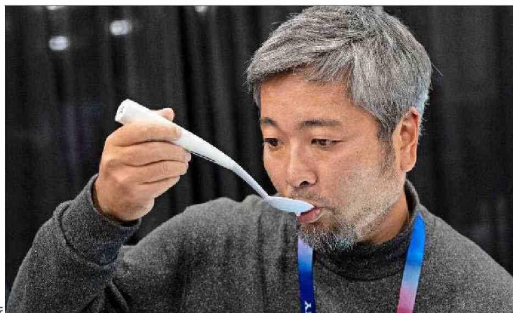
Al hacer fluir una suave corriente eléctrica, la cuchara concentra el sodio en la lengua y evita agregar sal en exceso. Kirin Electric Salt ya se vende en Japón.
