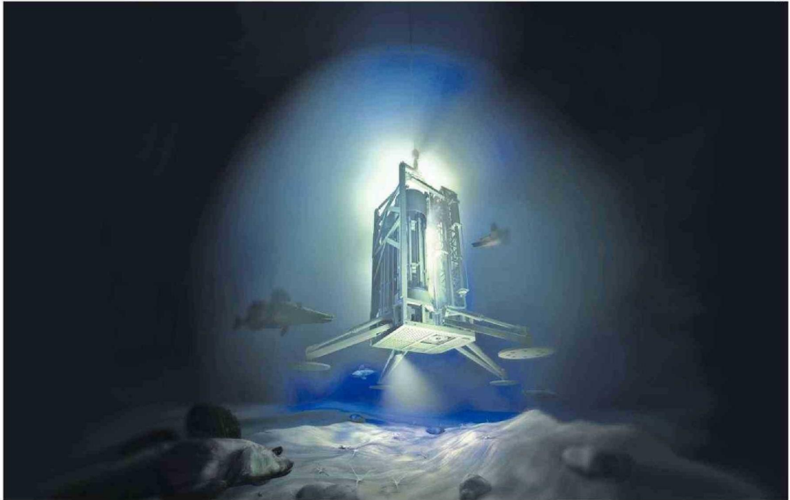
UNA REPRESENTACIÓN GRÁFICA DEL ATERRIZAJE DEL PERFORADOR MARUM-MEBO70 EN EL FONDO MARINO DEL MAR DE AMUNDSEN, EN LA ANTÁRTIDA.
