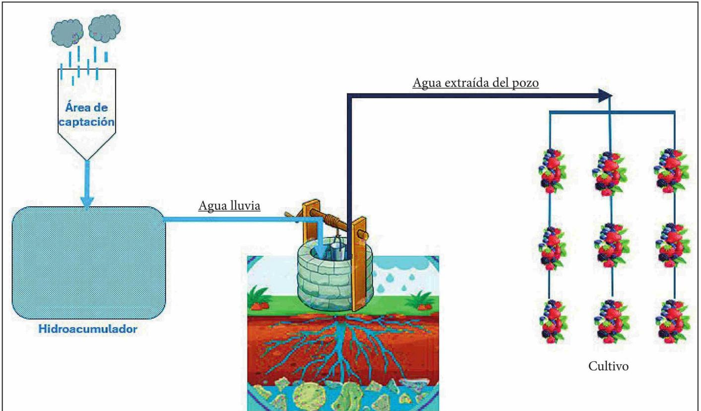
Sistema de recarga para pozos mediante agua lluvia.
