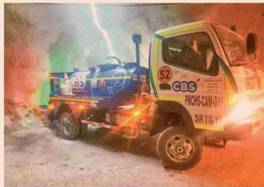
Camión adaptado para gestionar residuos líquidos en Chuquicamata Subterránea.
