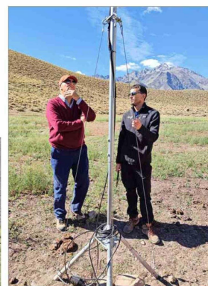
Para el monitoreo de aguas subterráneas se instalaron antenas de transmisión satelital como esta.
