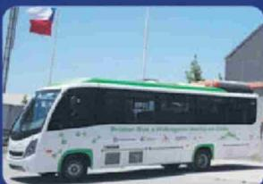
Su construcción implicó una inversión total de **US\$ 750.000**, financiados en partes iguales por **Anglo American, Colbún y Corfo**. Tiene capacidad para **30 pasajeros**, una autonomía de **600 kilómetros** (hidrógeno más batería) y alcanza una velocidad máxima de **90 km/h**.
