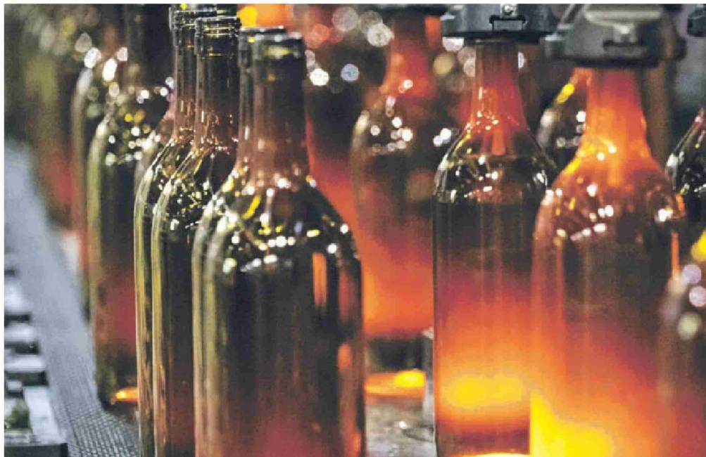
En España, el plan piloto de ACCIONA y Vidrala contempla la fabricación de 18,3 millones de botellas de vidrio a partir de 230 toneladas de escoria de biomasa.
