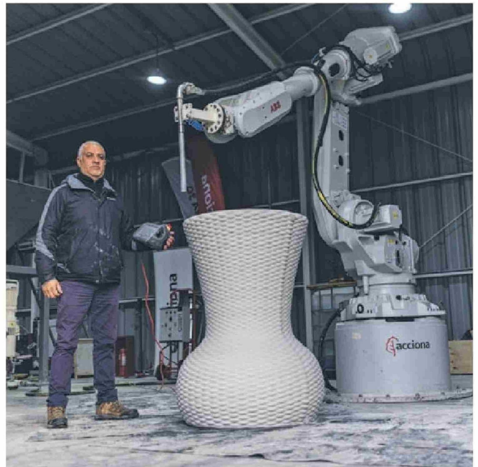
En Chile, el brazo robótico 3D de ACCIONA ha construido más de 60 piezas a partir de una mezcla de cemento y materiales reciclados. Foto: Pablo Sanhueza.
