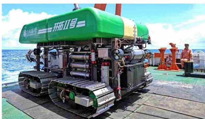
La maquinaria tiene 6 metros de largo, 3 de ancho y 2,5 de alto, y un peso de aproximadamente 14 toneladas.
