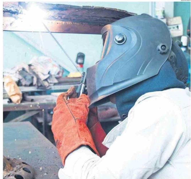
FORMACIÓN TEÓRICA Y PRÁCTICA EN SOLDADURA POR ARCO METÁLICO CON ELECTRODO REVESTIDO.
