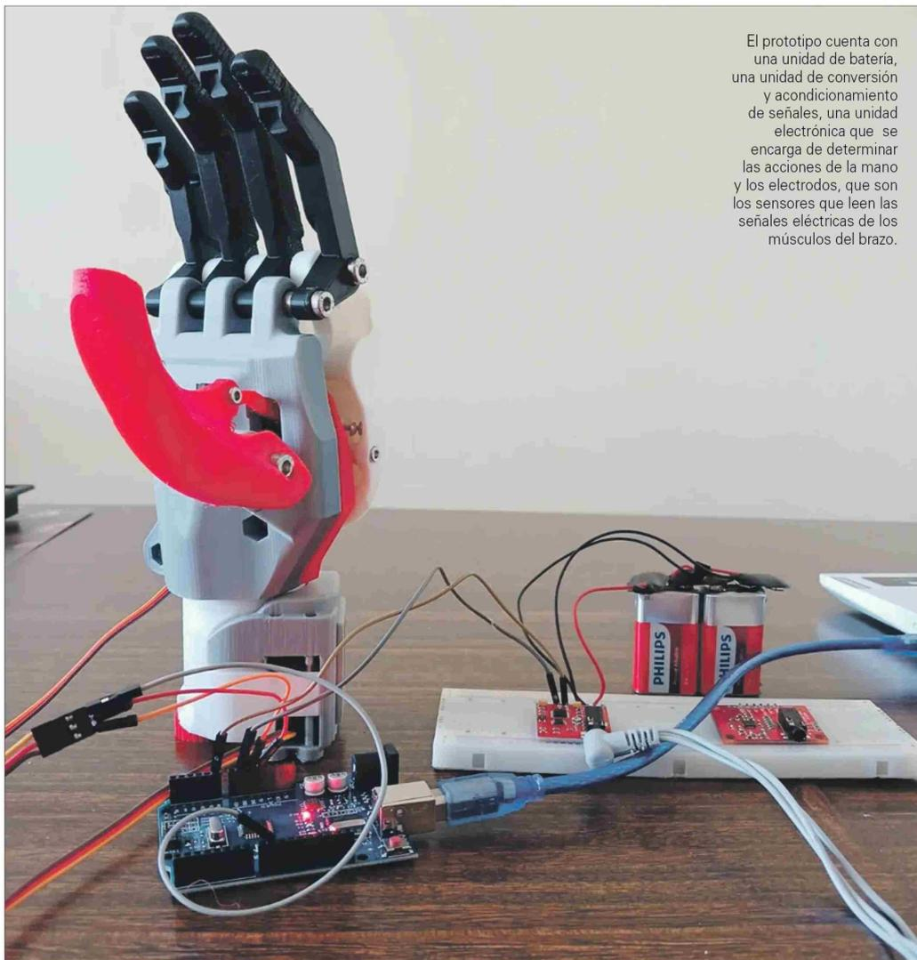
El prototipo cuenta con una unidad de batería, una unidad de conversión y acondicionamiento de señales, una unidad electrónica que se encarga de determinar las acciones de la mano y los electrodos, que son los sensores que leen las señales eléctricas de los músculos del brazo.
