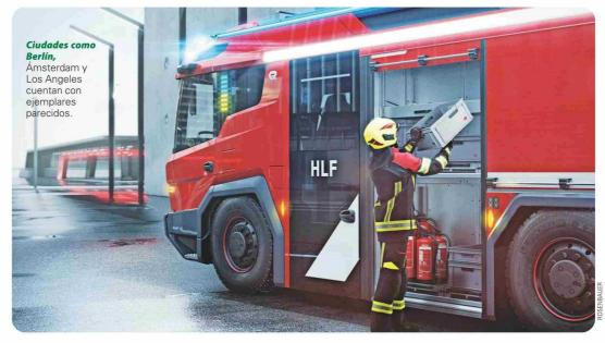
El vehículo tiene dos motores eléctricos con una potencia máxima de 490 HP, 135 km de autonomía, tracción 4x4 y ruedas traseras móviles, que le permiten desplazarse lateralmente.
