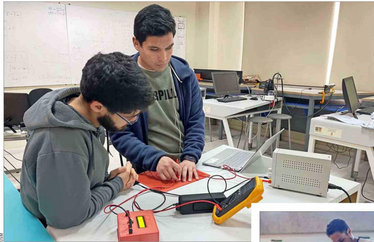
Un voltímetro adaptado para que universitarios con discapacidad visual puedan utilizarlo en clases, que incorpora audiolectura, es parte de las innovaciones inclusivas creadas y utilizadas en la U. Técnica Federico Santa María.
