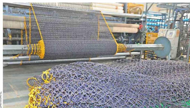
Confección de redes loberas en la planta de Garware en Wai, India, para la contención de depredadores y disuadir así sustentablemente, aportando a la protección de la biomasa en los centros salmonicultores.
