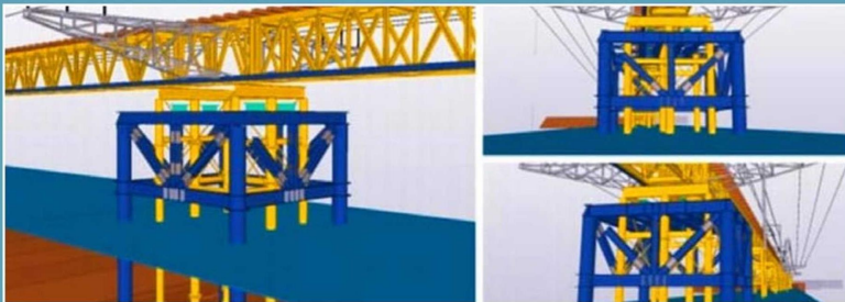
Así se repararán las 4 cepas dañadas
