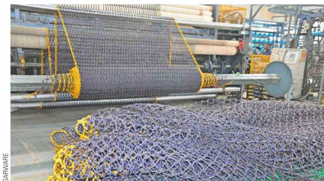
Confección de redes loberas en la planta de Garware en Wai, India, para la contención de depredadores y disuadir así sustentablemente, aportando a la protección de la biomasa en los centros salmonicultores.
