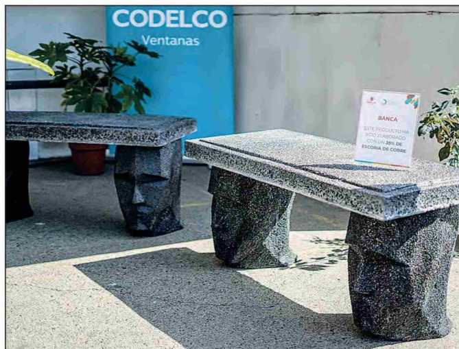
La idea de este proyecto es llegar a construir mobiliarios, como el de la imagen, con escoria de cobre.
