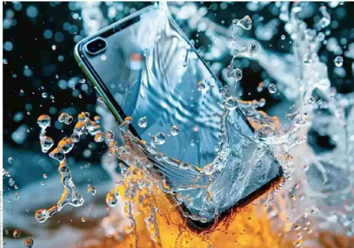
LA CLASIFICACIÓN IP67, por ejemplo, indica que el aparato es resistente al polvo y puede sumergirse en agua hasta 1 metro de profundidad durante 30 minutos.
