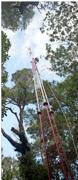
Aquí, la torre de flujo de carbono instalada en el bosque. Con ello midieron la cantidad de carbono que absorbía el ecosistema.
