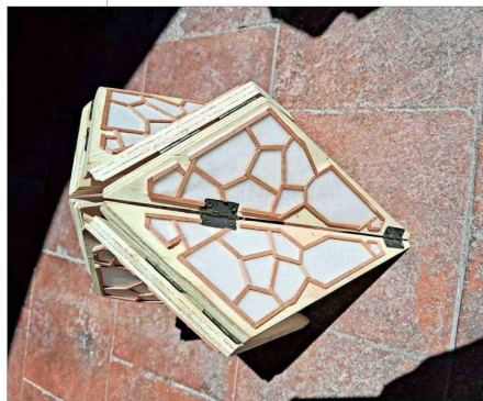
Un prototipo desarrollado por los investigadores: la estructura es de madera y una membrana (en color blanco) fabricada con alginato, presente ampliamente en las paredes celulares de las algas marinas pardas. La idea es que pronto estos biomateriales puedan estar disponibles en el mercado.
