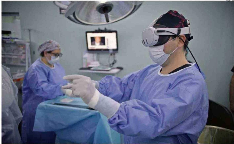
Los visores de realidad aumentada proyectan una pantalla virtual de alta definición frente al cirujano.
