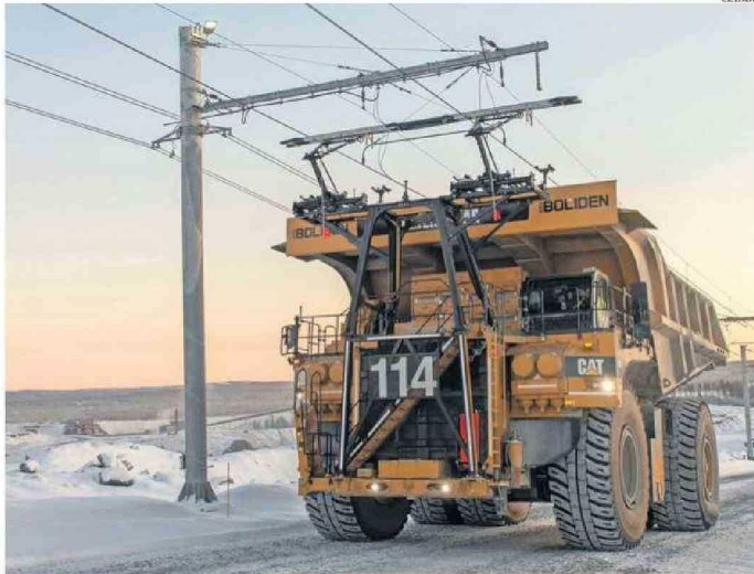
LA TECNOLOGÍA TROLLEY OPTIMIZA LAS OPERACIONES Y REDUCE EL IMPACTO AMBIENTAL DE LAS FLOTAS DE CAEX.
