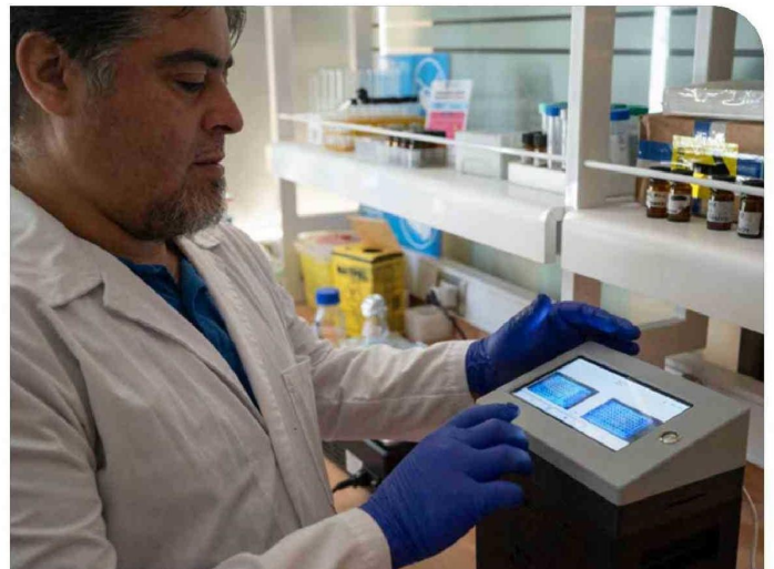
El kit es un biosensor que utiliza nanotecnología y un housing optoelectrónico para activar y procesar la señal fluorescente emitida en la detección de ADN de Mycobacterium bovis .
