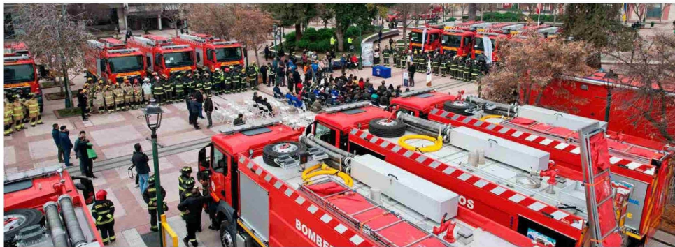
Los carros cisterna son marca Man Jacinto TGS 33.480 de 12.000 litros de capacidad, tracción 6x4, de 4 metros cúbicos de almacenamiento, bomba de alta y baja presión de 6.000 litros por minuto, pitón monitor en techo y pump and roll.
