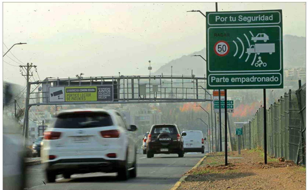
FISCALIZACIÓN. — Los telerradares tienen como objetivo detectar infracciones como exceso de velocidad, uso indebido de vías exclusivas o tránsito en zonas restringidas por razones ambientales.
