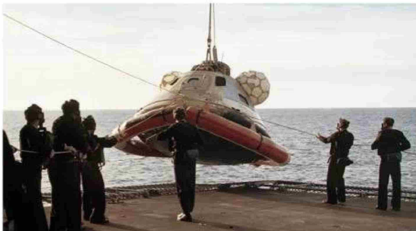
Después de completar una misión de 84 días, los astronautas Gerald P. Carr, Dr. Edward G. Gibson y William R. Pogue son izados a un barco de recuperación dentro de un módulo de comando.
