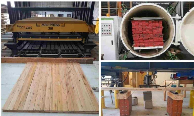
SE PROPUSO UN TRATAMIENTO QUE PERMITE PROCESAR rápido y adecuadamente eucalipto y lenga, resultando madera de buena calidad para desarrollar productos de ingeniería y ser usado en la construcción sostenible.
