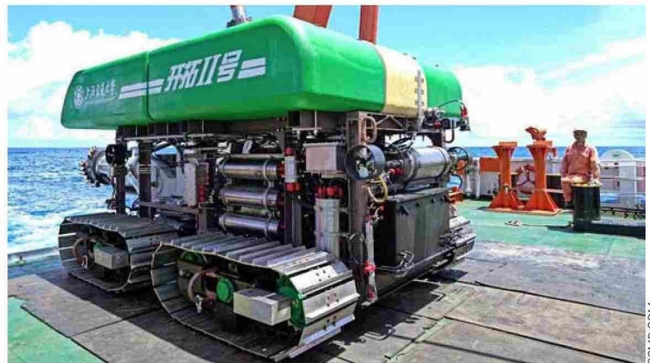
La maquinaria tiene 6 metros de largo, 3 de ancho y 2,5 de alto, y un peso de aproximadamente 14 toneladas.
