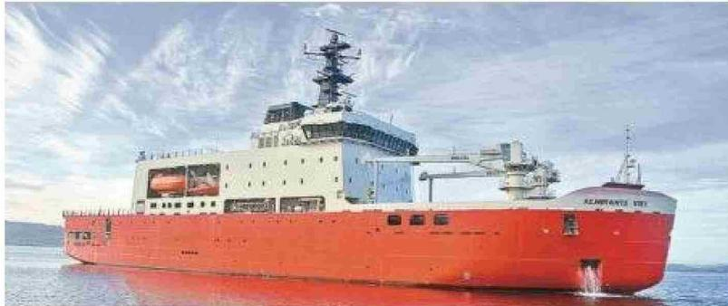
**El rompehielos tiene un complejo sistema tecnológico y es una estructura flotante capaz de moverse a una velocidad superior a 15 nudos. Tiene una autonomía para navegar 60 días y puede transportar 86 tripulantes y 34 científicos.**
