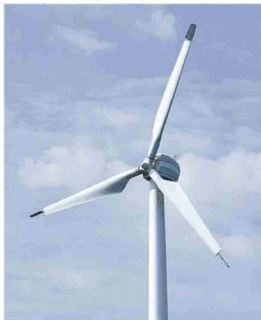
Los sistemas encargados de generar energía eléctrica a partir del viento, son denominados aerogeneradores, y son una versión más compleja y sofisticada de los molinos de viento.
