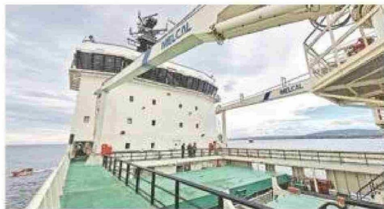
Las grúas tienen una capacidad para soportar 25 toneladas cada una.
