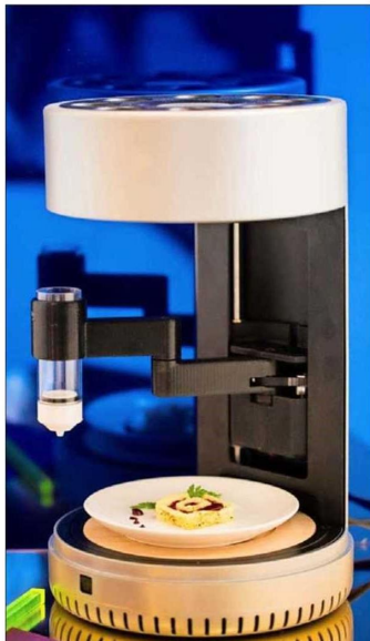
Sanna, una impresora 3D de alimentos creada por el equipo de ingenieros de la U. de Columbia que trabajó en la impresión del cheesecake .
