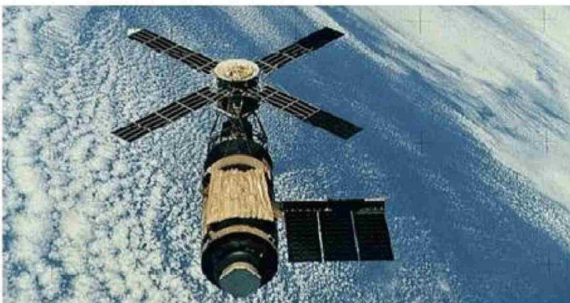
Skylab orbitando la Tierra. Fue la primera estación espacial experimental de Estados Unidos. Contenía paneles solares, un observatorio, un laboratorio, un taller y otros sistemas.
