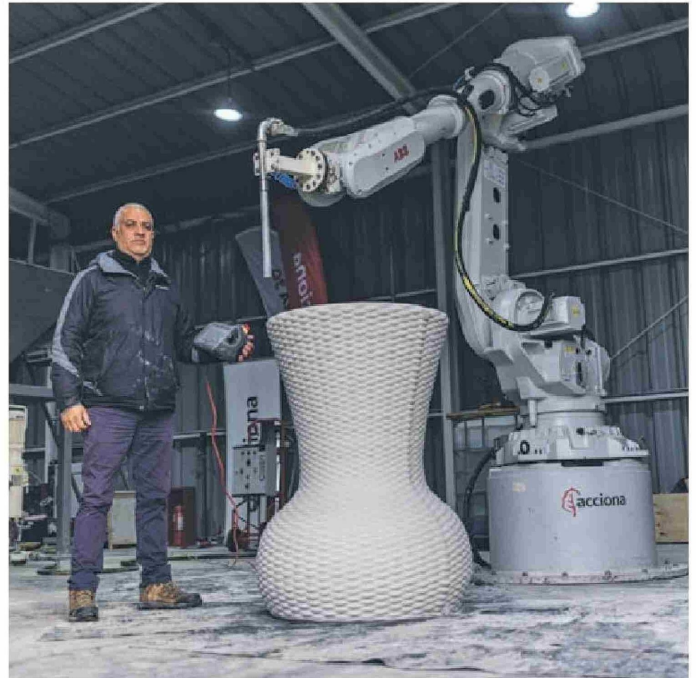
En Chile, el brazo robótico 3D de ACCIONA ha construido más de 60 piezas a partir de una mezcla de cemento y materiales reciclados. Foto: Pablo Sanhueza.
