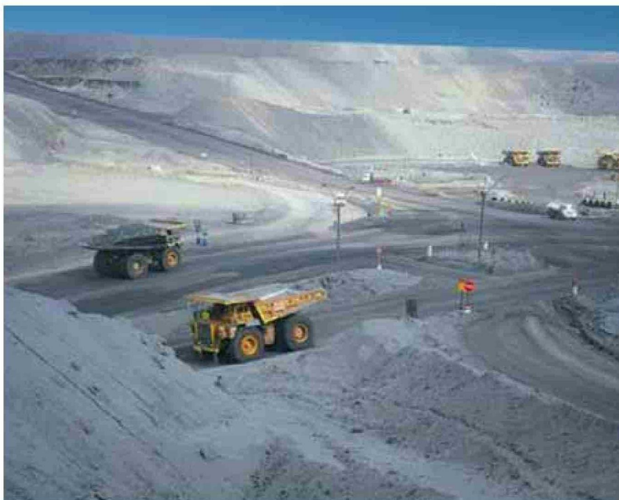
☰ Con el supresor de polvo H14 de Vialcorp, es posible ahorrar un 90% en consumo de agua para riego de caminos mineros.
