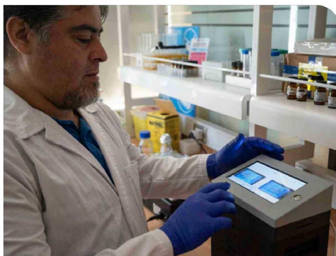
El kit es un biosensor que utiliza nanotecnología y un housing optoelectrónico para activar y procesar la señal fluorescente emitida en la detección de ADN de Mycobacterium bovis .
