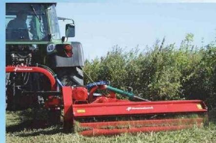
sistema de muelles que equilibra el peso de la barra de corte. Esto permite un trabajo eficiente incluso en suelos irregulares. Además, el sistema breakback evita daños al permitir que la barra se desplace hacia atrás
